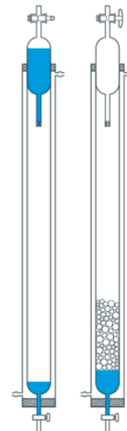
Figur 15: Forsøksoppsettet til Ross-Miles metoden før (venstre) og etter (høyre) blanding av løsningene (Küss Scientific, u.d.).
