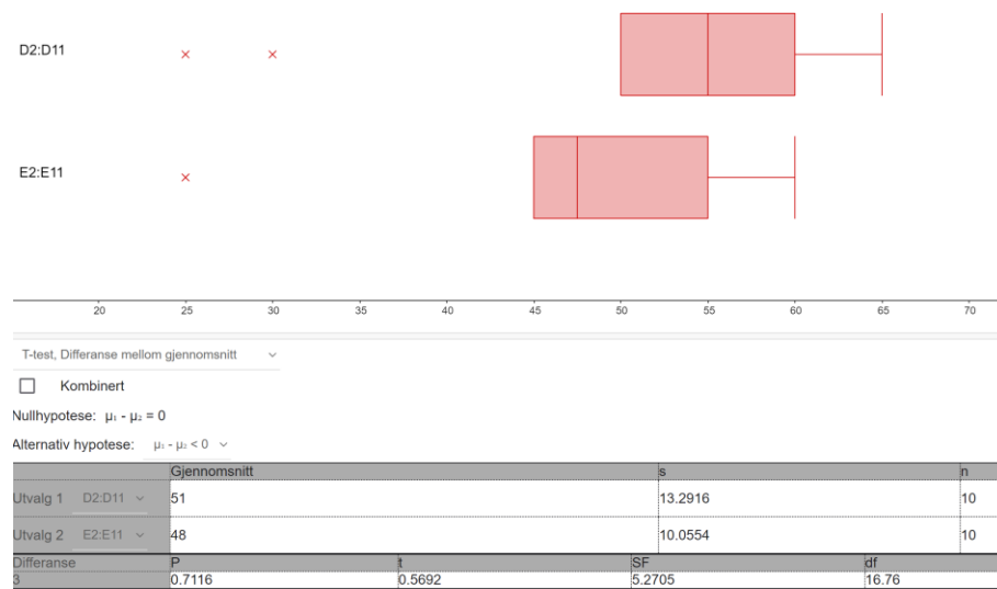
Figur 17 – T-test med en alternativ hypotese lik at forskjellen mellom de to datasettene er mindre enn null.
