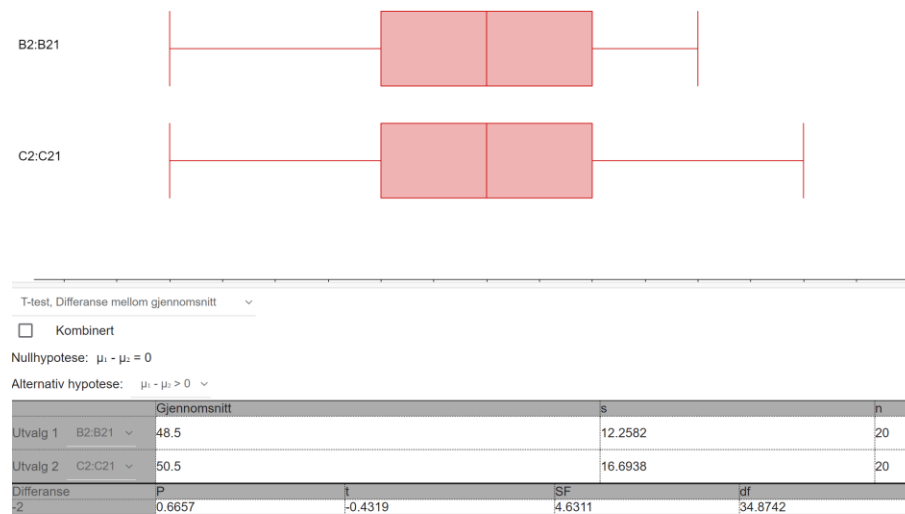
Figur 10 – T-test med en alternativ hypotese lik at forskjellen mellom de to datasettene er større enn null.
